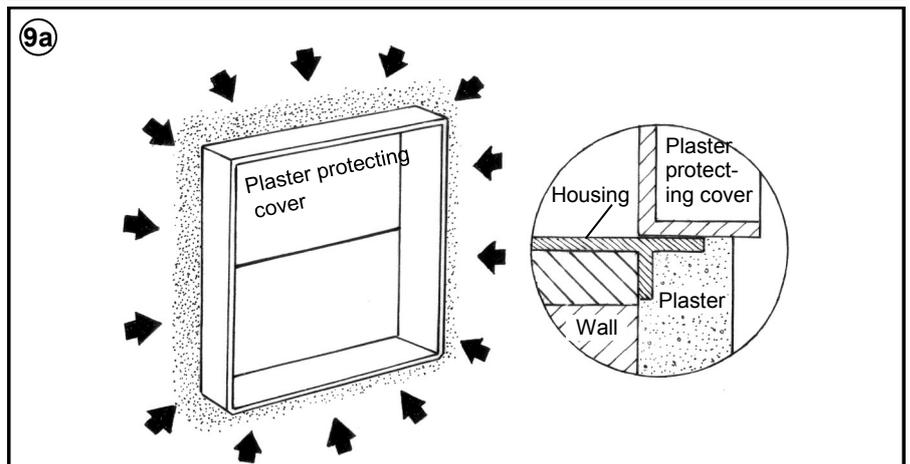
**Assembly of fan insert:**
