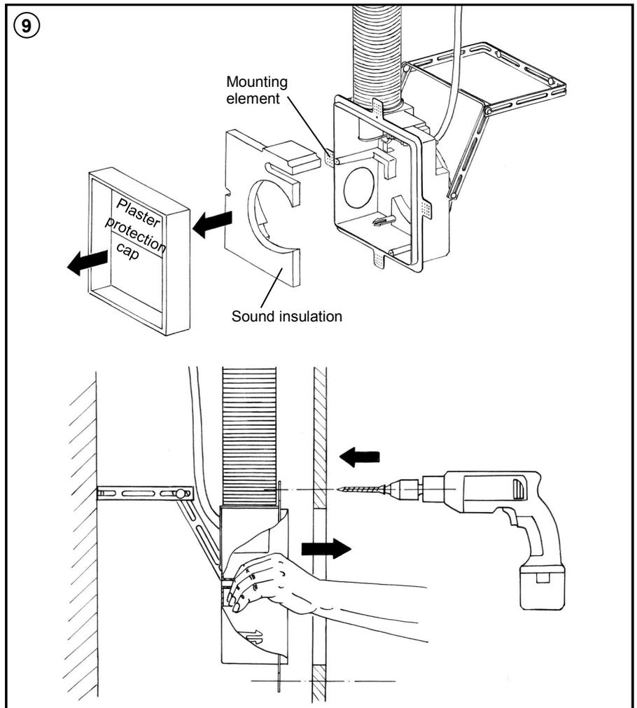
**Put the plaster protection cap back on:**
