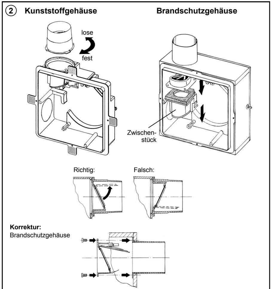
**Montagebügel mit beiliegenden Schraubenzubehör am Gehäuse montieren.**
