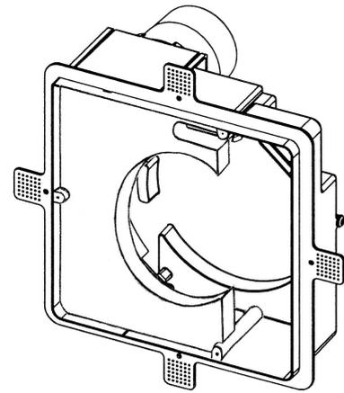
Kunststoffgehäuse mit axialer Ausblasöffnung Typ 3/UP-A
