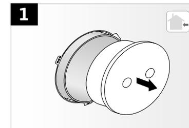
Anschließend nehmen Sie den Wandanschluss [6] von der Außenblende [7] und schieben diesen über das Wanddurchführungsrohr. Nutzen Sie den Wandanschluss als Schablone und zeichnen Sie die Bohrlöcher zur Befestigung an (Abb. 2).
