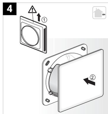
Im nächsten Schritt setzen Sie bitte die Außenblende [7] mit der geschlossenen Kante nach oben auf den Wandanschluss – achten Sie dabei darauf, dass die Schnappverbindungen einrasten (Abb. 4).
